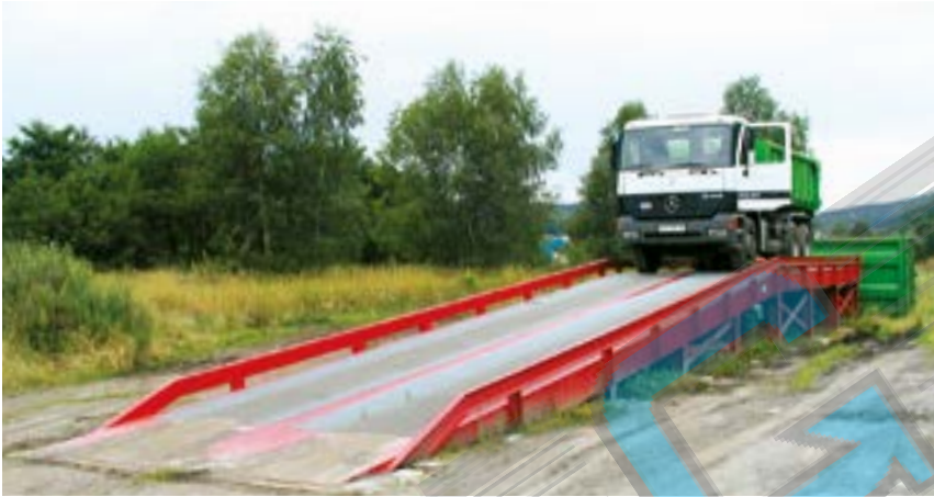
Rampe 24 tonnes pour le déchargement des camions bennes
