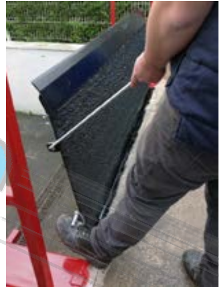
Levier de manipulation et déblocage du verrou de sécurité
