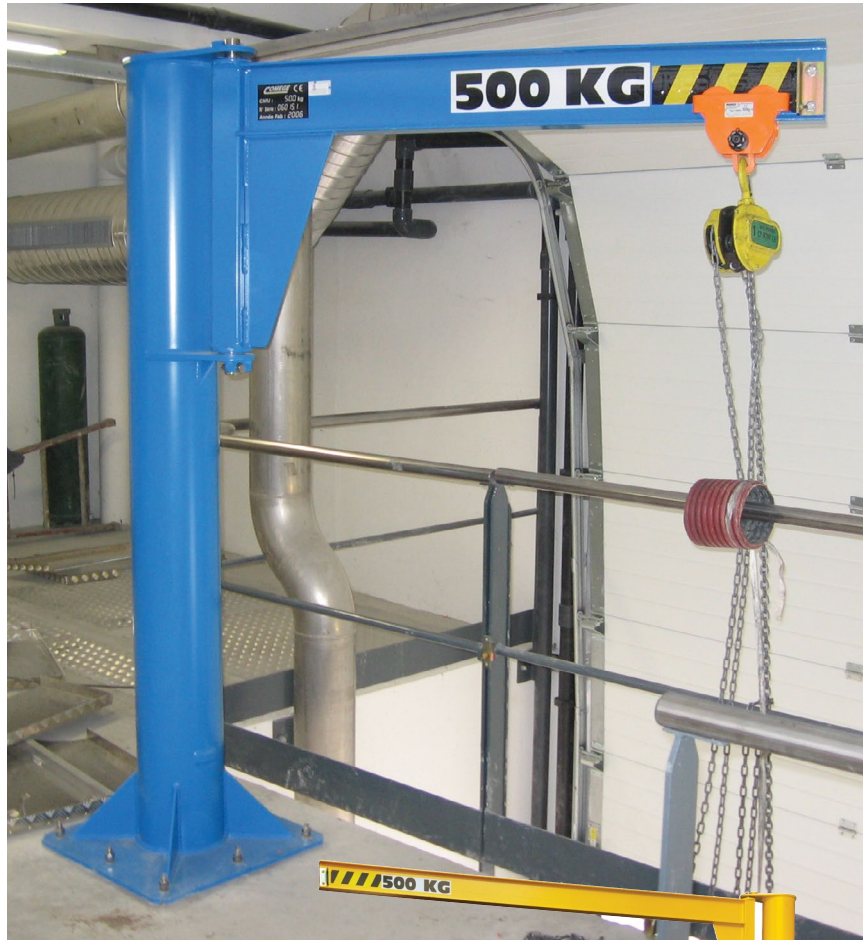
Potence sur fût inversée 500 kg rotation 270° Equipée d'un palan manuel à chaîne
