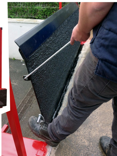
Levier de manipulation et déblocage du verrou de sécurité
