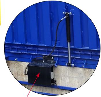
par électrovanne hydraulique et clapet pare-chute intégré au vérin
