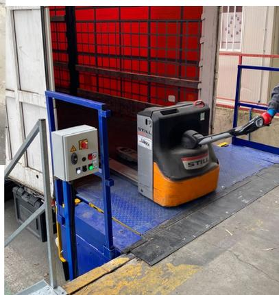
Boîtier de commande Logic Block
