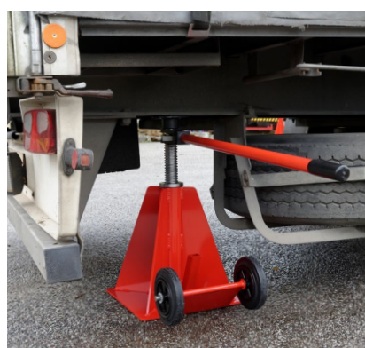
Q10-2007 en position de travail sous le longeron
